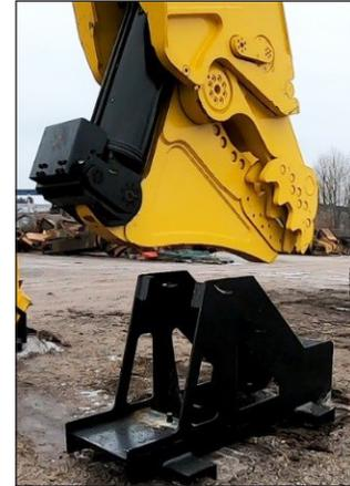
Appuyez sur l'interrupteur CYL de la console de commande de la cabine et maintenez-le enfoncé, actionnez le levier ou la pédale de commande approprié(e) pour déployer la goupille du vérin.
