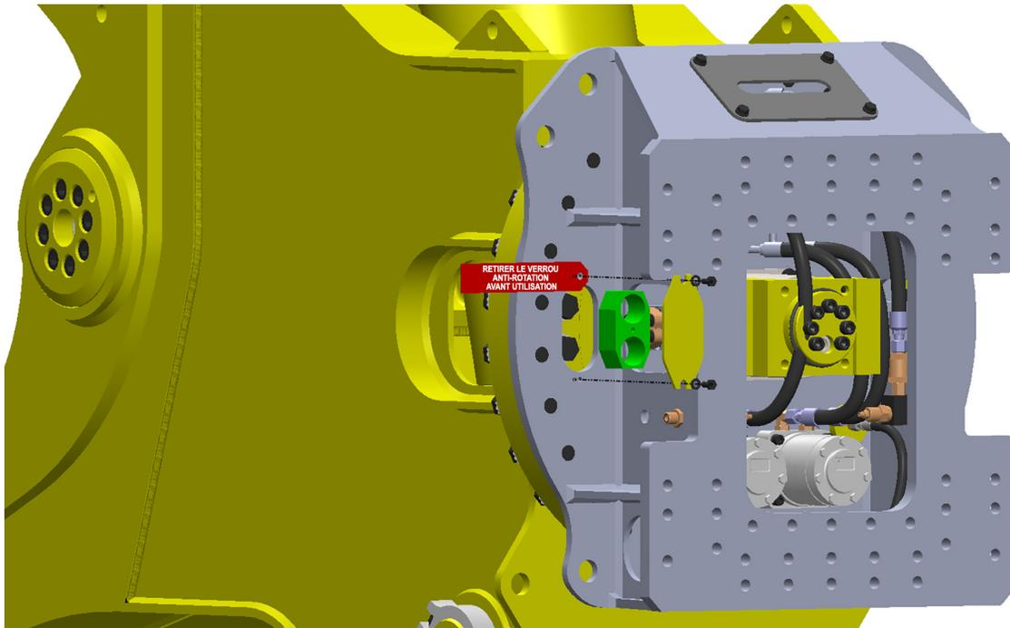
Les verrous anti-rotation (transport) sont installés en usine pour permettre l'expédition du support avec les goupilles de montage orientées vers le haut. Ceci est avantageux pour l'utilisateur final lors du retrait de l'accessoire du camion et son montage sur l'excavatrice.
