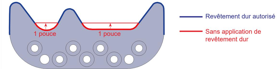
Un revêtement dur dans les zones rouges peut entraîner une défaillance prématurée des dents. Toujours construire/réaliser un revêtement dur dans le sens du grain de la dent. Ne pas souder en travers de la dent.
