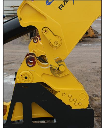
Lorsque le corps est contre la butée du jeu de mâchoires, les goupilles du corps peuvent être rétractées. Appuyez sur l'interrupteur BODY de la console de commande de la cabine et maintenez-le enfoncé, puis actionnez le levier ou la pédale de commande approprié(e) pour rétracter les goupilles du corps. Relâchez l'interrupteur BODY lorsque les goupilles sont complètement rétractées.
