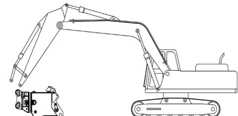
Relevez lentement la flèche pour soulever l'accessoire, en permettant à la connexion du pivot du vérin de venir à portée de la course du vérin de l'excavatrice.
