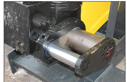
Appuyez sur l'interrupteur BODY de la console de commande de la cabine et maintenez-le enfoncé, actionnez le levier ou la pédale de commande approprié(e) pour déployer les goupilles du corps.
