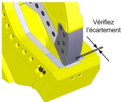
1. Fermez lentement les mâchoires jusqu'à ce que les lames de perçage soient au même niveau que le bord supérieur de la lame de rasoir.
