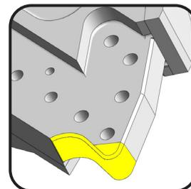
Les boulons des lames de perçage ne doivent pas entrer en contact brutal avec les trous de boulons du talon supérieur. Dans de rares cas, il a été constaté qu'un alignement incorrect des trous de boulons d'une lame de perçage et des trous de boulons du talon peut entraîner la rupture des lames de perçage à travers les trous de boulons.
