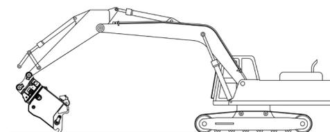
Installez les tuyaux hydrauliques de l'excavatrice, alimentation et retour, de l'extrémité du bras aux blocs du collecteur de l'accessoire. Voir la page 23 pour l'installation électrique.
