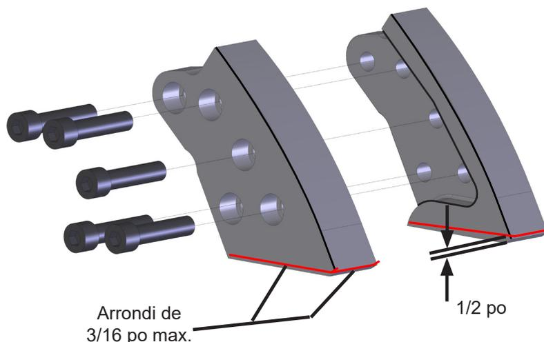
7. La largeur des lames, de haut en bas, peut s'amincir de 0,060 po (2 mm) au total. Les bords inférieurs peuvent être usés jusqu'à un arrondi maximum de 3/16 po (5 mm).
