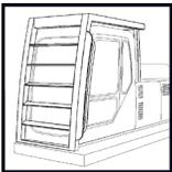
Évitez autant que possible de manipuler des matériaux au-dessus de votre tête. Des protections de cabine en verre de sécurité et en treillis métallique doivent être installées pour protéger l'opérateur des débris volants qui peuvent être générés pendant la manutention. Les structures de protection contre les chutes d'objets sont nécessaires pour toute utilisation où du matériel doit être manipulé en hauteur.
