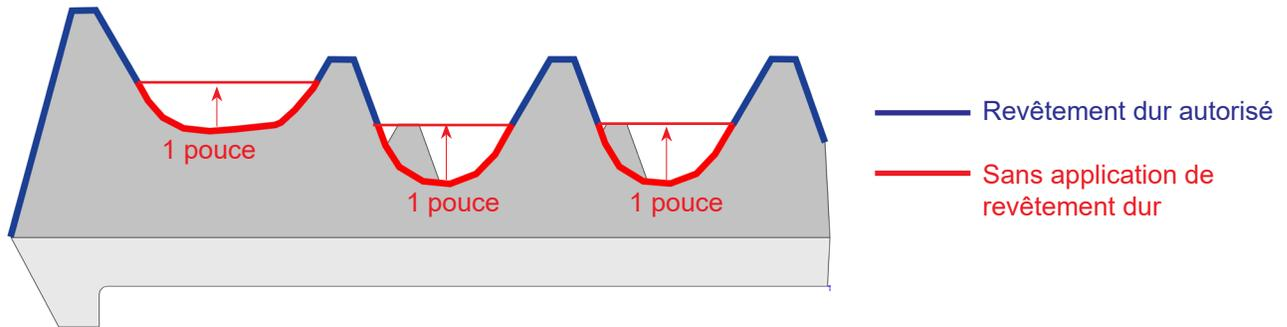
Un revêtement dur dans les zones rouges peut entraîner une défaillance prématurée des dents. Toujours construire/réaliser un revêtement dur dans le sens du grain de la dent. Ne pas souder en travers de la dent.
