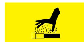
Enlevez la peinture avant de souder ou de chauffer une pièce peinte. Des fumées/poussières dangereuses peuvent être générées lorsque de la peinture est chauffée par soudage, brasage ou utilisation d'un chalumeau. Effectuez tous les travaux à l'extérieur ou dans un endroit bien ventilé et disposez correctement de la peinture et du solvant.
