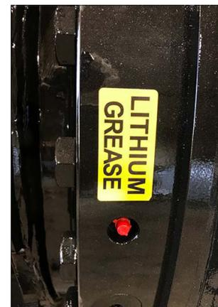
La graisse au lithium Genesis GLG-2(MC) anti-usure pour pression extrême (référence 6302601) est recommandée pour toutes les conditions de température.
