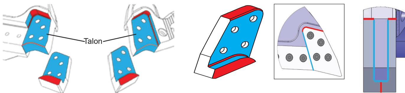
Si nécessaire, reconstituez le bord inférieur avant du talon et la surface verticale avant de la partie supérieure (zones **surlignées en jaune**), en suivant les procédures indiquées dans ce manuel. Après le soudage, les surfaces doivent être équarries à l'aide d'une meuleuse et finies à l'aide d'une lime et d'une règle de machiniste.
