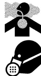
Si vous poncez ou meulez de la peinture, évitez de respirer la poussière. Portez un appareil respiratoire homologué. Si vous utilisez un solvant ou un décapant, enlevez le décapant avec de l'eau et du savon avant de souder. Retirez les récipients de solvant ou de décapant et les autres matériaux inflammables du lieu de travail. Laissez les vapeurs se disperser au moins 15 minutes avant de souder ou de chauffer.
