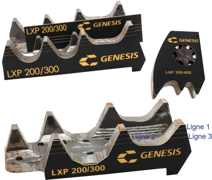
Un bon entretien des dents des équipements de démolition permet d'optimiser la performance et la durée de vie des pièces de rechange. À mesure que les dents s'usent, elles doivent être tournées, rechargées ou remplacées.
