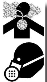
Al lijar o amolar pintura, evite inhalar el polvo. Utilice un respirador aprobado. Si utiliza solvente o removedor de pintura, retire el removedor con agua y jabón antes de soldar. Retire los recipientes de solvente o removedor de pintura y demás materiales inflamables del área. Deje que los vapores se dispersen durante 15 minutos, por lo menos, antes de soldar o calentar.
