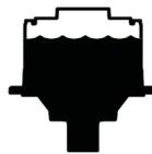
**Recordatorio:** El nivel de aceite de la caja de engranajes debería estar a entre 1,25 pulgadas y 1,5 pulgadas (entre 31 mm y 38 mm) por debajo del tapón de llenado con la caja de engranajes en posición vertical.
