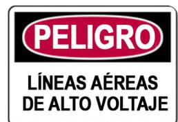
La corriente de las líneas de alto voltaje podría tener una descarga eléctrica a cierta distancia del cable en una conexión a tierra cerca. Mantenga todas las partes de la máquina por lo menos a 50 pies (16 m) de distancia de las líneas eléctricas.
