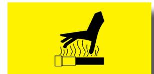
Éliminez la peinture avant de souder ou d'utiliser un procédé thermique. Des fumées/poussières dangereuses peuvent être générées lorsque de la peinture est chauffée par du soudage, du brasage ou l'utilisation d'un chalumeau. Effectuez tout le travail à l'extérieur ou dans une zone bien ventilée et éliminez de façon appropriée les restes de peinture et de solvant.
