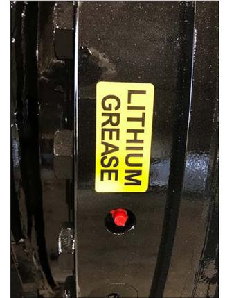
La graisse au lithium Genesis GLG-2<sup>MC</sup> anti-usure pour pression extrême (référence 6302601) est recommandée pour toutes les conditions de température.
