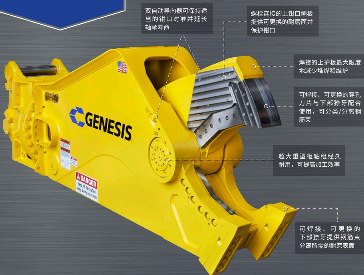
双自动导向器可保持适当的钳口对准并延长轴承寿命
