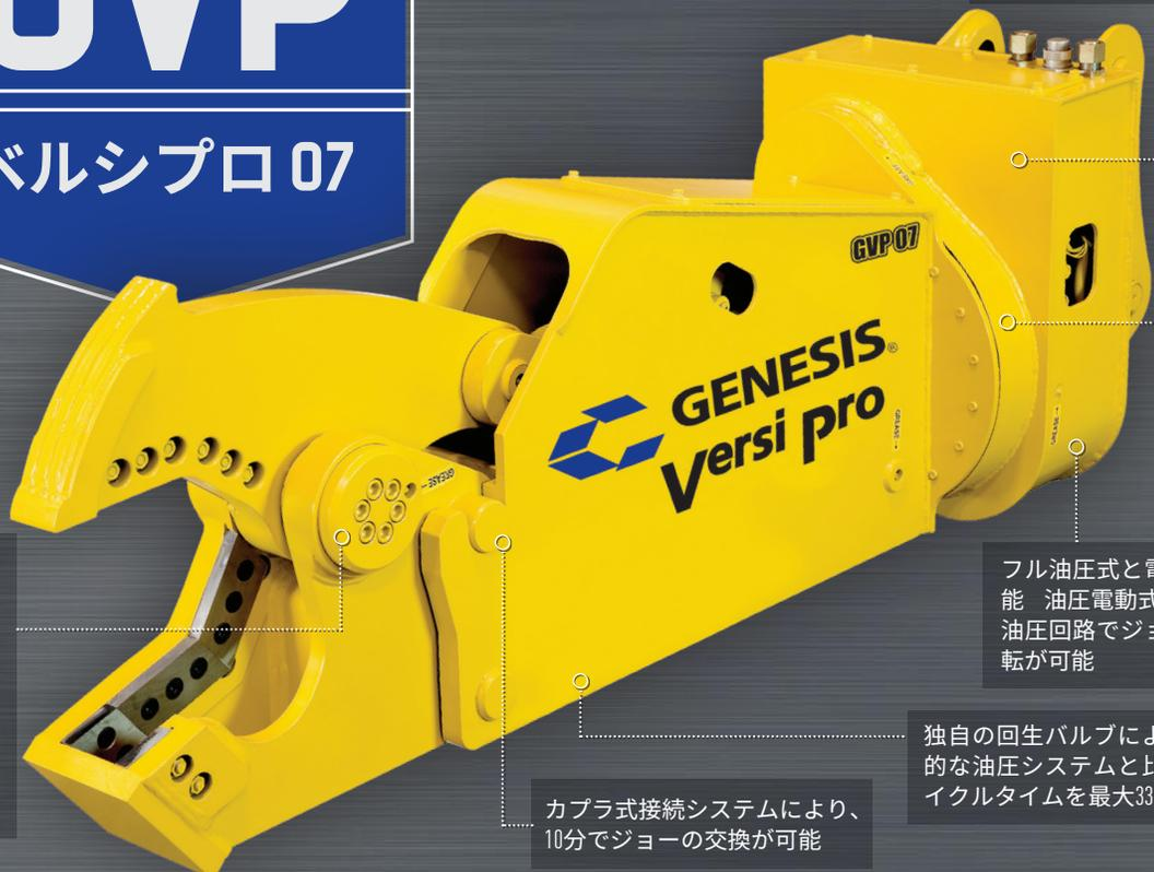
革新的なブラケットシステムにより、スキッドステアのクイックプレートやミニショベルのラグプレートを10分で交換可能
