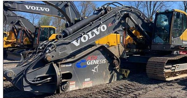
Siga los procedimientos del fabricante para arrancar y calentar el sistema hidráulico de la excavadora. No opere el circuito del accesorio durante el período de calentamiento.
