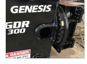
Por eso, es importante realizar una inspección de los pernos de corona de giro cada ocho horas de operación. Estos pernos no se pueden reutilizar ni volver a ajustar, y los pernos sueltos o rotos, junto con los pernos en cualquiera de los lados, deben reemplazarse de inmediato.
