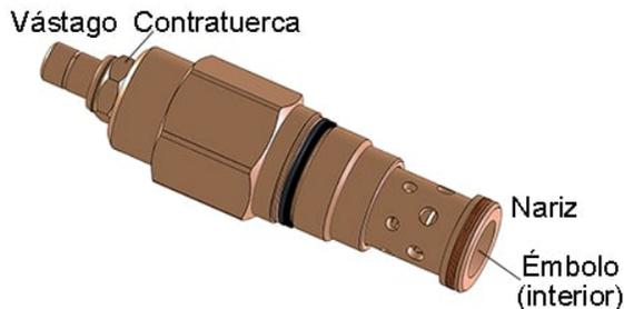
Vuelva a girar el vástago a su posición original y ajuste la contratuerca. Vuelva a instalar la válvula en el colector de control de movimiento y ajuste con una torsión de 150 ft-lb.
