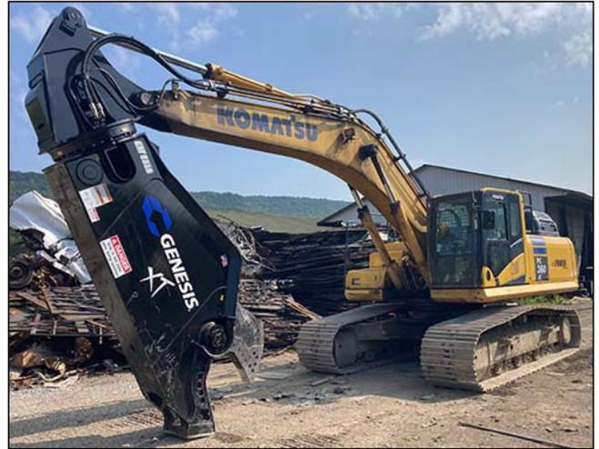
Si cette orientation n'est pas respectée, il y aura une contre-pression excessive lors de l'ouverture de la mâchoire, car le volume d'huile côté alésage de la cisaille est près du double de celui qui entre dans le côté de la tige du cylindre pour le rétracter. L'étranglement de la tige du tiroir de l'excavatrice entraîne une restriction du volume important d'huile qui tente de passer du côté de l'alésage du cylindre de la cisaille.
