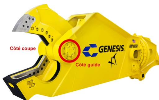
Une défaillance du boulon d'embout peut également résulter du traitement du câble haute résistance. Lorsque les lames sont émoussées, le câble ne se coupe pas complètement et se coince entre les lames de coupe principales supérieure et inférieure. Cela applique une force extrême entre les lames et pousse l'arbre principal latéralement dans le bouchon d'embout, en faisant ressortir les têtes de boulon.
