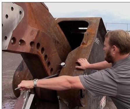
Le roulement principal s'use davantage du côté coupant, ce qui entraîne la torsion de l'arbre principal vers le roulement côté guide. L'extrémité de l'arbre principal entre alors en contact avec la rondelle de butée sous l'embout, en biais et non à plat, contre elle. Cela entraîne un chargement par points provoquant la défaillance des têtes de boulons d'embout aux positions de 6 à 9 heures sur l'embout.
