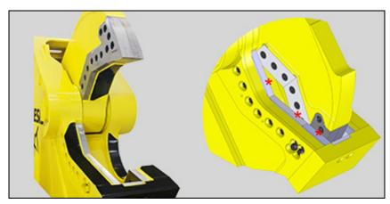
Les lames de perçage et les lames de guidage sont les plus sensibles à ce phénomène et présentent des stries bleues sur leur face. Dans certains cas, elles deviennent si chaudes que des fissures de surface et des éclaboussures apparaissent. La chaleur et l'expansion de la lame écartent également la mâchoire inférieure et augmentent les espaces entre les lames primaires et secondaires, ce qui provoque le blocage de matériaux fins entre elles.
