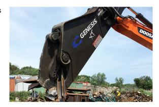
Des espaces insuffisants entre les lames de perçage et les lames de guidage soumettent les lames et le matériau de base de la mâchoire à une dilatation thermique due à la friction de coupe. Plus les lames sont serrées, plus elles chauffent et plus elles se dilatent.
