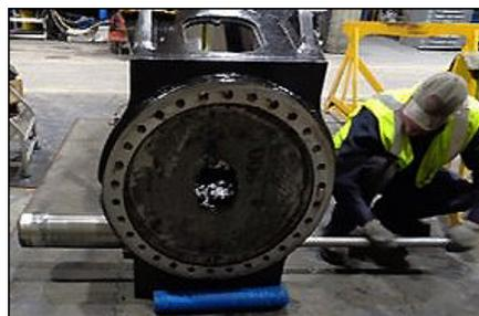
Retirez le maintien de goupille de la goupille et du collier du vérin arrière, puis retirez la goupille du vérin arrière. Notez que le vérin se déplacera car il n'est plus fixé à la cisaille.
