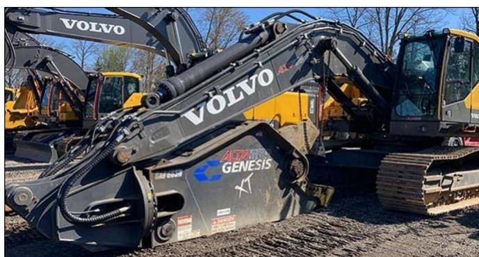
Suivez les procédures de l'équipementier pour démarrer et le chauffer le système hydraulique de l'excavatrice. Ne faites pas fonctionner le circuit de l'accessoire pendant la période de préchauffage.
