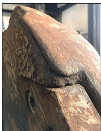
Il est également extrêmement difficile de réaliser une installation rétroactive du système Jaw Armor sur des cisailles très usées, en raison de l'usure déjà subie par les surfaces de la mâchoire et du besoin d'un alignement précis. Souvent, une telle installation est possible, mais il faut y accorder beaucoup de temps et d'attention pour assurer que le système Jaw Armor soit installé et configuré correctement.
