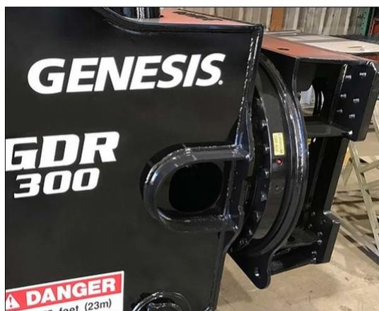
Il est donc important de vérifier visuellement les boulons de la couronne d'orientation toutes les huit heures de fonctionnement. Ces boulons ne peuvent pas être réutilisés ou resserrés, et les boulons desserrés ou cassés, ainsi que les boulons de chaque côté, doivent être immédiatement remplacés.
